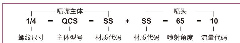
如需NPT螺纹接口, 请在喷嘴的接口尺寸前加字母“N”。
