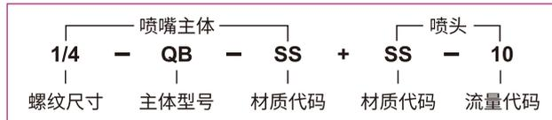
如需NPT螺纹接口,请在喷嘴的接口尺寸前加字母“N”。
