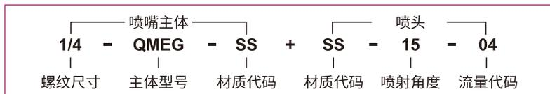
如需NPT螺纹接口, 请在喷嘴的接口尺寸前加字母“N”。
