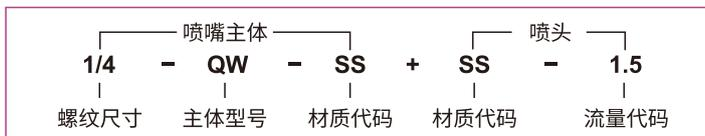
如需NPT螺纹接口, 请在喷嘴的接口尺寸前加字母“N”。
