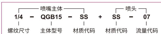
如需NPT螺纹接口, 请在喷嘴的接口尺寸前加字母“N”。
